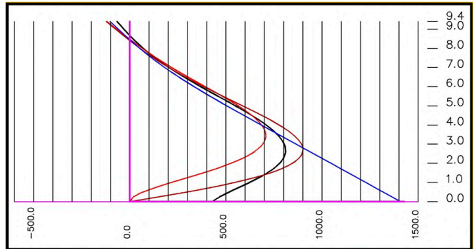
Şekil XIV.4. Duvar yüksekliği boyunca çembersel çekme (Tonf/m) Duvar altında sınır şartı Serbest, Basit mesnet, Ankastre, Alt çember kirişi
