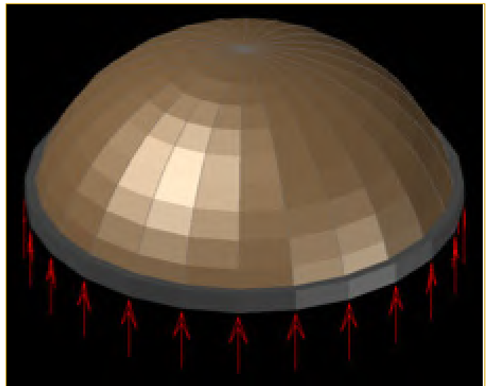
Şekil III.2.1. Sınır şartı yatayda hareketli ve mafsallı kubbe
