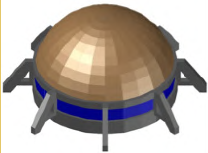
Şekil III.2.2. Sınır şartı ankastre kubbe
