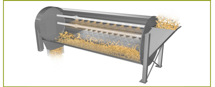
Şekil 183 OSB yongalarının tamburlu tutkallama makinesinde enjektörlerle tutkallanması.
