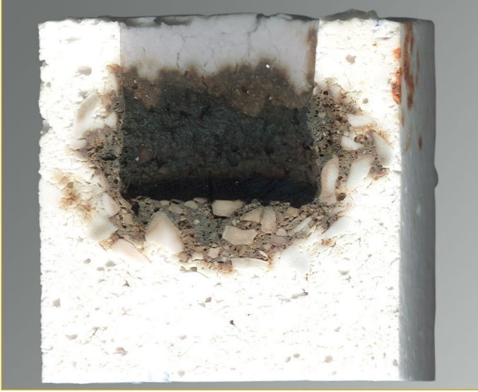
Şekil 5.22. Cüruf-Refrakter Etkileşimi Sağlanmış Refrakter Örneğinin A-A Kesit Görünümü 97
