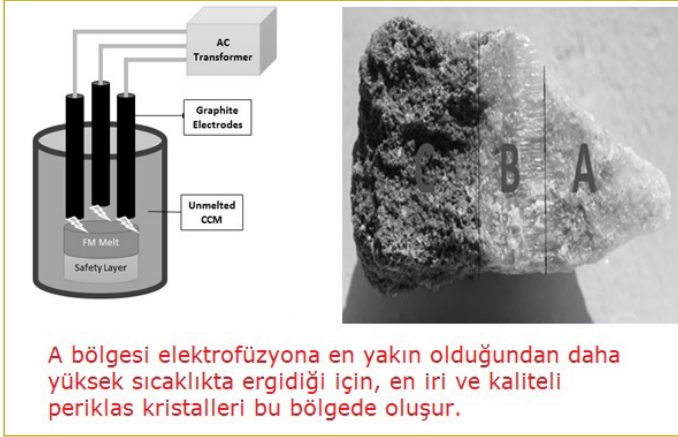
Şekil 2.13. EAF'da Fused (Ergimiş) MgO Üretim Prosesinin Şematik Gösterimi ve Elde Edilen Fused Magnezya Agrega Ürünü 16
