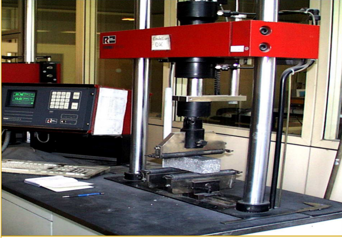
Şekil 5.14. Soğukta Eğme Mukavemeti; MOR Testi ve 3-Nokta Eğme Testi Düzenegi, Test Numunesi ve Testin Şematik Gösterimi 70
