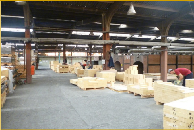
Şekil 3.13. Refrakter Tuğlaların Paketlenmesi/Ambalajlı Halde Sevkiyata Hazır Hale Getirilmesi. 36
