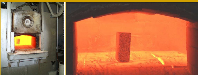
Şekil 5.9 a-b Isıl Şok Testinde Fırını, Numune ve Test Düzenliği Görüntüleri 70
