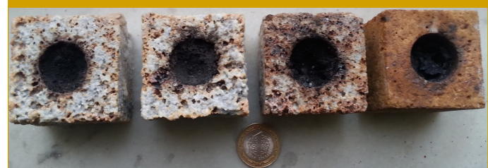
Şekil 5.21. 1.600 °C'de 2 Saat Cüruf-Refrakter Etkileşimi Sağlanmış Refrakter Potalar 91,98
