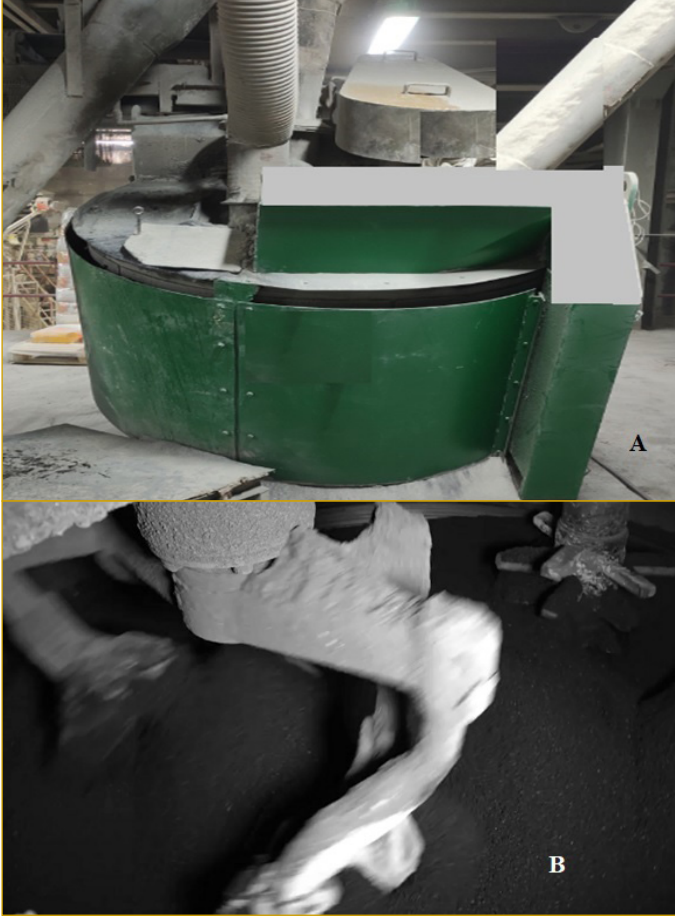
Şekil 3.4(a-b). a. Yıldız karıştırıcı pan tipi karıştırıcı ve b. Karışma ortamı ve nemli harman. 36
