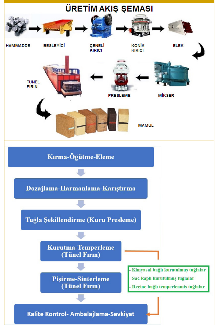
Şekil 3.3a-b. Refrakter Tuğla Üretim Prosesinin Aşamaları. 36
