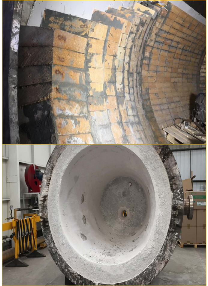
Şekil 3.2 a-b. A. Tuğla Tipi Refrakter Astarlama ve B. Dökülebilir Refrakter Astarlama Örnekleri
