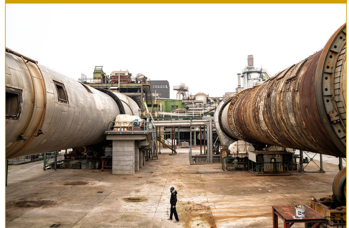
Şekil 2.11. Kalsine ve Sinter MgO Üretimi için Yatay Döner Fırını (rotary kiln) 14
