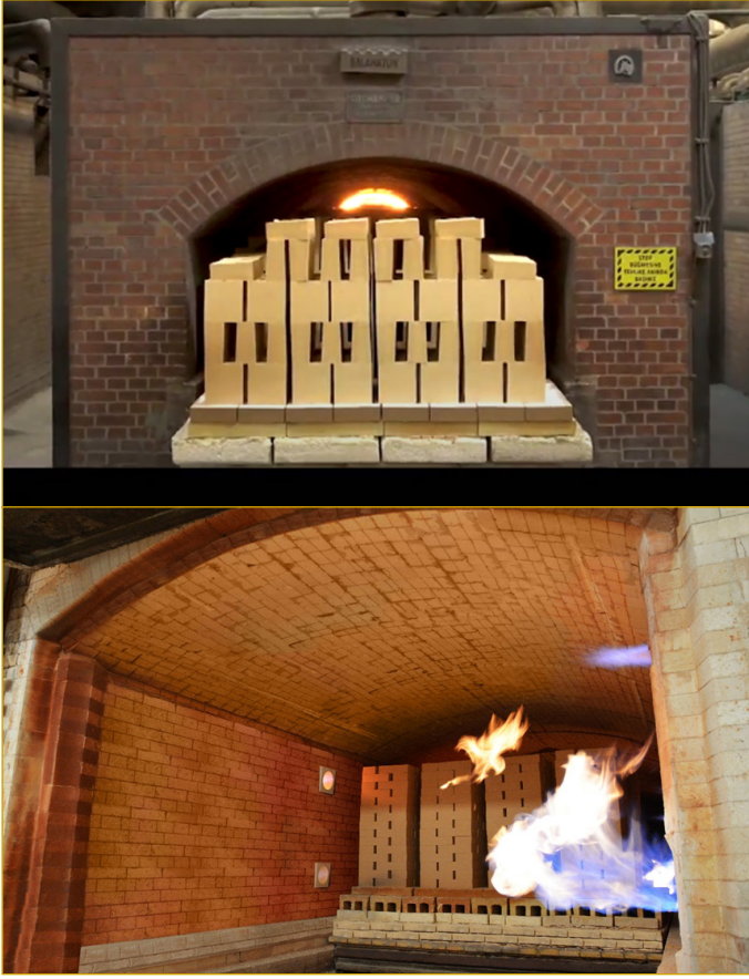
Şekil 3.8. Tünel Fırın ve Tuğlaların Paletlerle Fırına Yükleme Görüntüleri. 36
