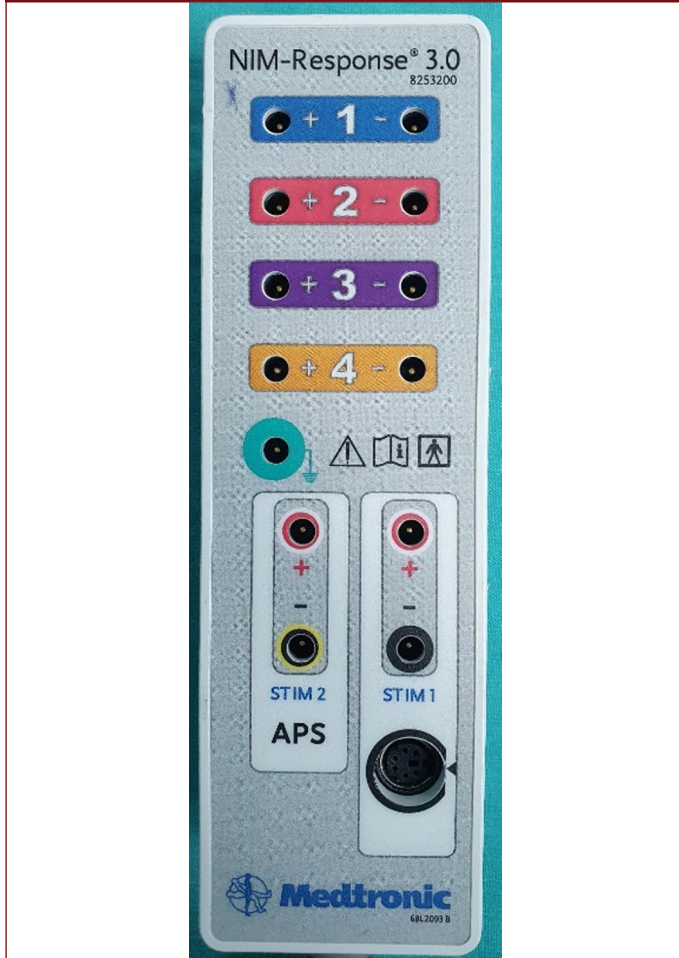
Şekil 1: Kranial sinir monitörizasyonunda 4 kanallı alıcı elektrod sistemi
