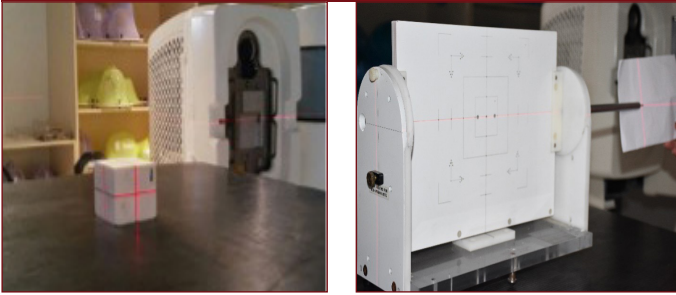
Şekil 3. Küple ve mekanik kalite kontrol aleti kullanarak lazer kontrolü
