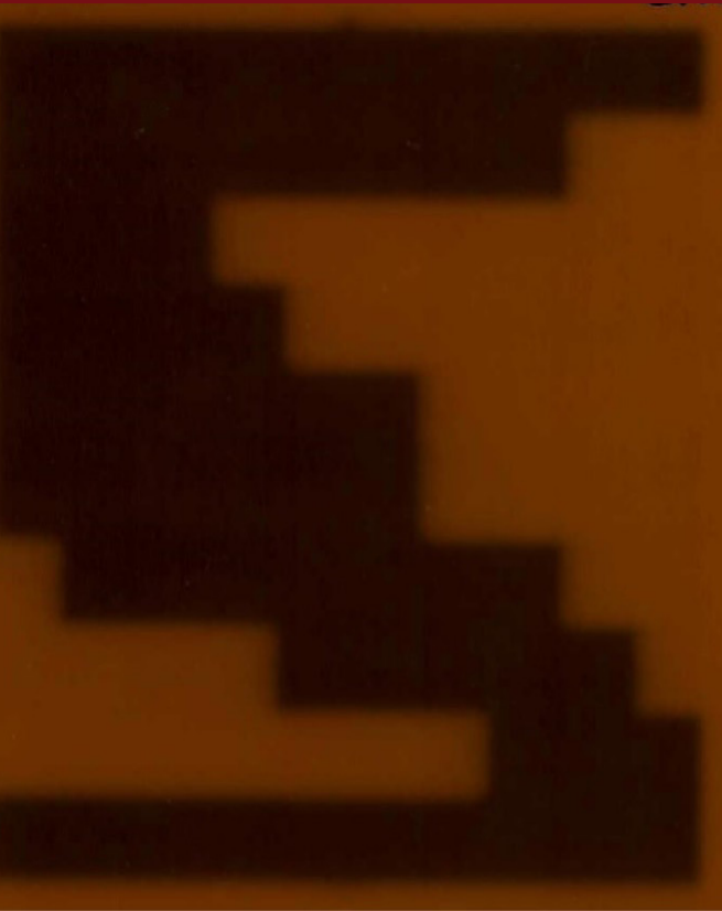
Şekil 15. Gafkromik QA filmi ile elde edilmiş lif pozisyon doęruluęu testi
